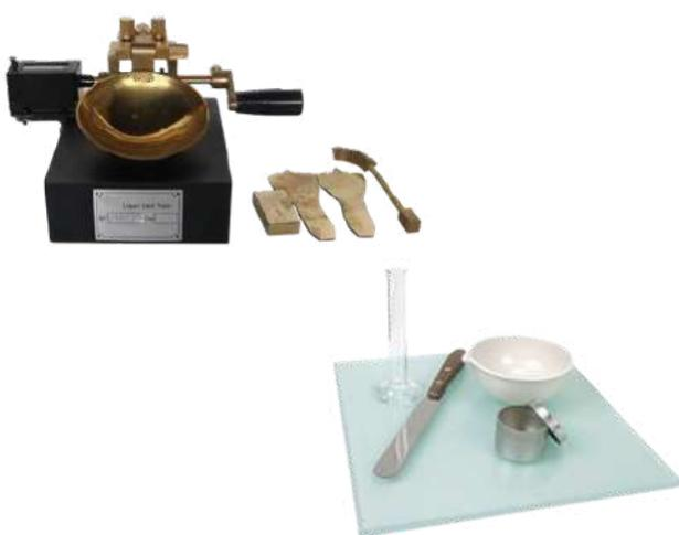
Pengujian Atterberg Limit mencakup 2 pengujian yaitu pengujian batas cair dan batas plastis. Tujuan pengujian batas cair adalah untuk menentukan kadar air tanah saat tanah berubah dari kondisi plastis menjadi kondisi cair sedangkan batas plastis adalah kondisi dimana kadar air tanah berubah dari kondisi plastis menjadi semi padat (menentukan kadar air terendah tanah). Dari kedua uji ini akan didapatkan nilai Index Plastisitas yang merupakan nilai kadar air tanah dalam kondisi plastis.
